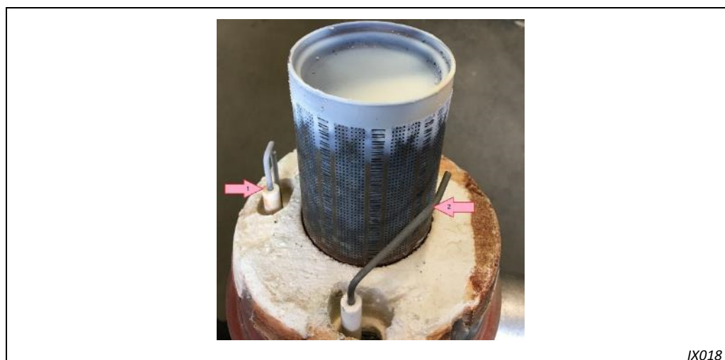
Abbildung 25 Brenner mit Überwachungs (2)- und Zündelektrode (1)
