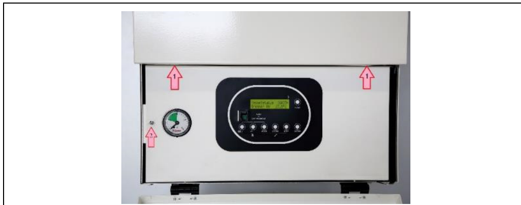
Abbildung 22 Verschlusschrauben der Haube lösen
