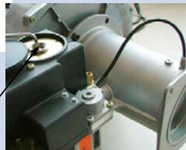
Zuerst CO<sub>2</sub> Einstellung bei Großlast mit Schraube (Pfeil) auf erforderlichen Wert einstellen.
