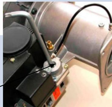
Dann CO<sub>2</sub> Einstellung bei Kleinlast mit dem Druckregler (Schraube Pfeil) auf das erforderliche Niveau einstellen
