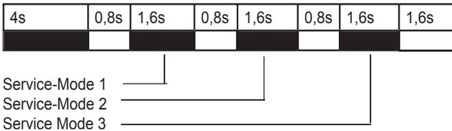
Wird der Entstörknopf zum falschen Zeitpunkt gedrückt signalisiert der AirFlex den „Abbruch“-Blinkcode und der AirFlex geht in den Normalbetrieb zurück. Der Ablauf muß in diesem Fall wiederholt werden.
