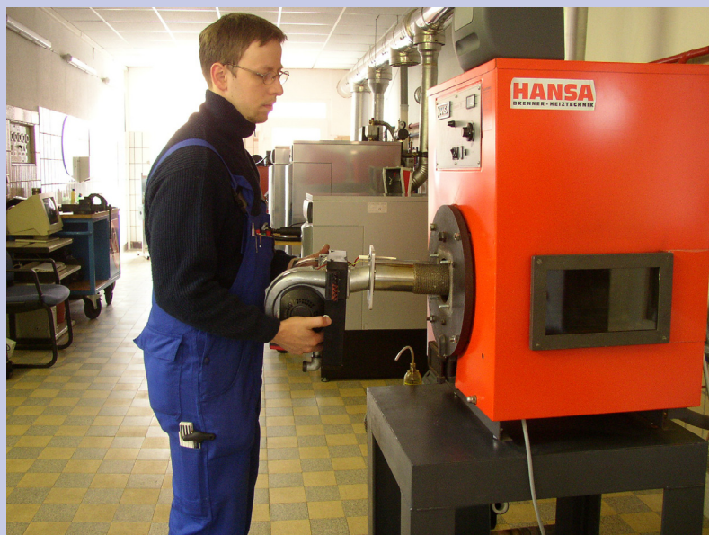
Der Brenner wird einfach in den Kessel eingeführt
