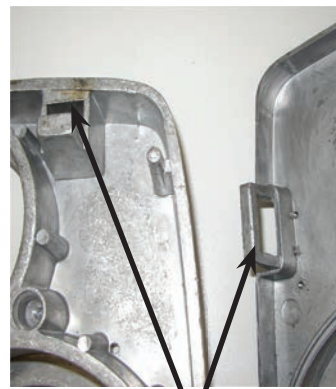
Diese Aufhängung darf nicht beschädigt werden
